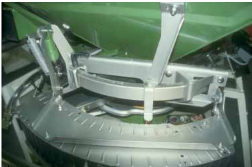
Défecteur à réglage par coulissement (Amazone)
